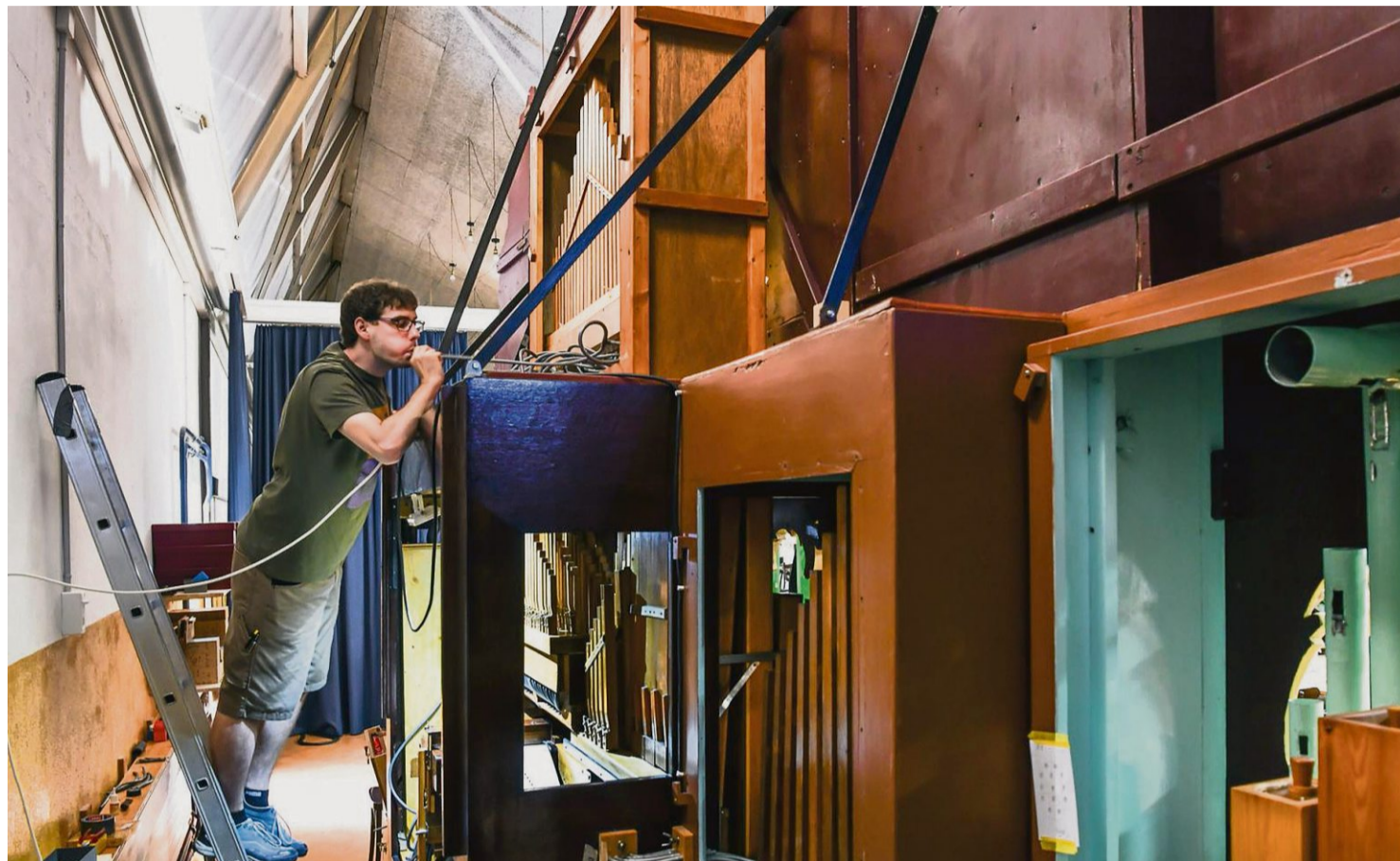
Langer Schnauf: Der Orgel- und Klavierbauer Oliver Zanella bläst Luft in einen Schlauch und bringt so eine Pfeife zum Tönen.
